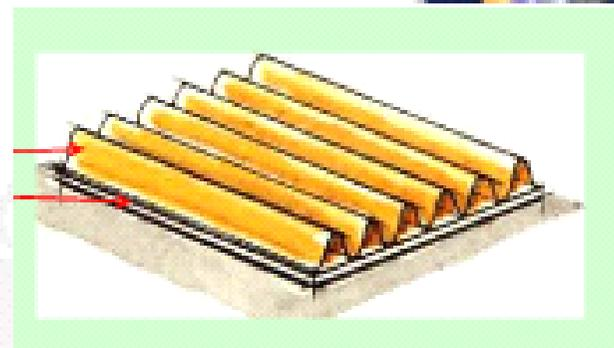
瓦楞原纸一般用磨木浆、半化学浆、废纸浆等制造，也有用混合浆料制造。国内的瓦楞原纸过去大多以草浆为主，配以部分半化学浆或废纸浆
